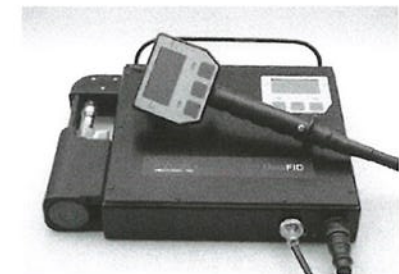
รูปที่ 10 แสดงตัวอย่างเครื่องตรวจวัดระดับสารระเหยอินทรีย์ชนิดเฟรมไอออนไนส์เซชัน (Frame Ionization Detector: FID)
